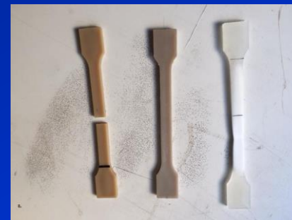
セルロースナノファイバーとプラスチック複合材料の試験片
